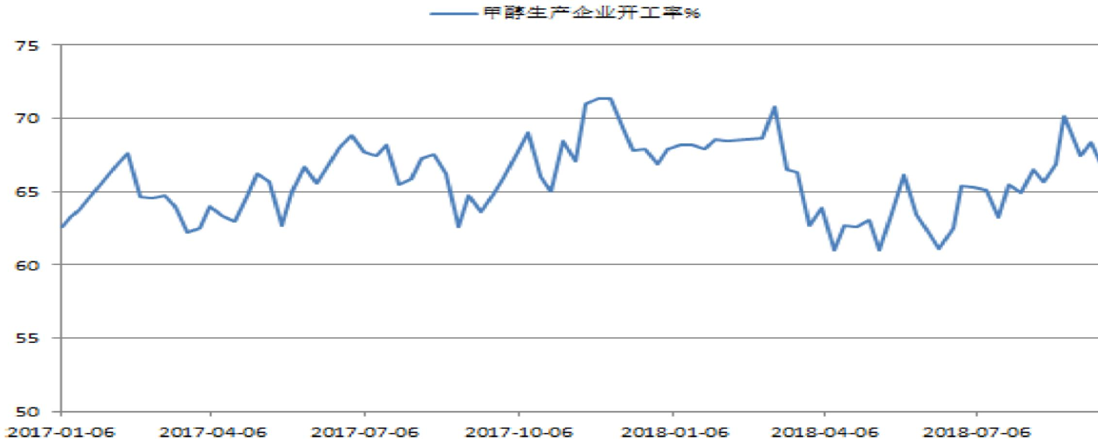
上半年装置集中检修开工率下滑，下半年生产企业利润较好复产开工回升，但四季度采暖季受“煤改气”、天然气限气、环保限产等政策因素影响，焦炉气装置将停车，届时开工率将出现下滑。
